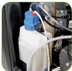
Dispositivo anticalcare con pompa controllata da una scheda elettronica. La quantità del prodotto può essere regolata in relazione alla durezza dell'acqua.
