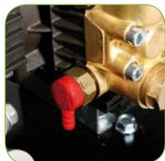
La versione C H1811Pi P è dotata di valvola termostatica che preserva la pompa da eventuale surriscaldamento dell'acqua.
