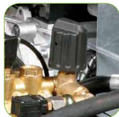
Manopola per la regolazione della pressione e per la fase vapore accessibile dall'esterno.
