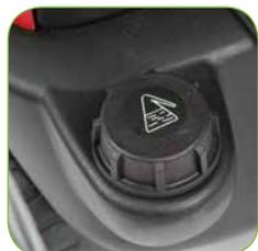
Serbatoio detergente incorporato dalla capacità di 7,5 litri che consente l'erogazione del prodotto in bassa pressione.
