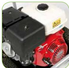
Motori a benzina, Honda serie GX, 4 tempi con valvole in testa e raffreddamento ad aria.
